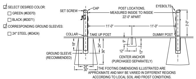
NOTE: ENSURE PULLEY ON CAP IS FACING AWAY FROM THE COURT AND THE NET CABLE IS INSTALLED DOWN THE SIDE OF THE POST AND INTO GEARS. IT SHOULD **NOT** BE INSTALLED DOWN THROUGH THE CAP. SEE NET INSTALLATION INSTRUCTIONS FOR AN ILLUSTRATION.
